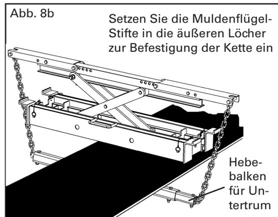
**SCHRITT 10. Das Band anheben.** Drehen Sie die Einstellmutter gegen den Uhrzeigersinn, bis das Band die gewünschte Höhe hat. (Verwenden Sie eine Nuss der korrekten Größe und das entsprechende Werkzeug - nicht im Lieferumfang enthalten.) Entfernen Sie vor Beginn der Arbeiten die Ratsche bzw. das Gerät.
